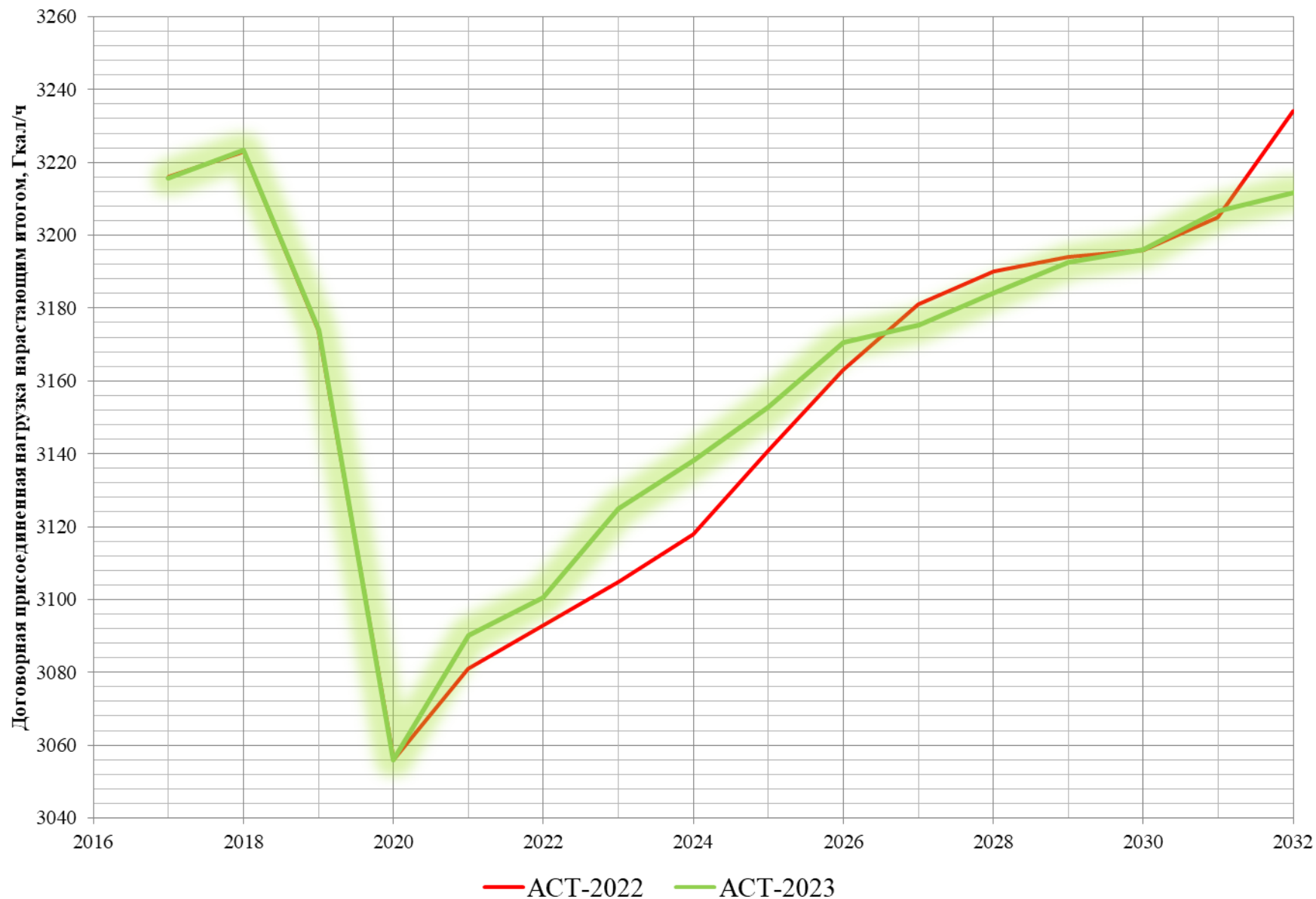
Рисунок 5.5 - Сравнительная динамика изменения максимальной тепловой нагрузки потребителей по актуализированной на 2023 год и актуализированной на 2022 год Схеме теплоснабжения
